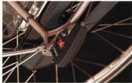
Zowel de SilverAce als de SilverAceLady zijn voorzien van een speciale kettingspaninrichting. De ketting wordt door een kettingkast gespannen die is vastgezet aan de achtervork. De kettingkast is een speciale constructie die de ketting makkelijk kan openen en sluiten voor het monteren of verwijderen van het achterwiel. De ketting is gespannen tussen de achteruitgang van de motor en de achterkettingring. De kettingkast heeft een slot om de ketting te bevechten.
